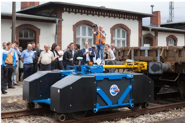
**Versuchsträger während der Live-Demonstration des automatisierten Rangierens im Rail & Logistic Center Wustermark mit geladenen Gästen aus der Bahnbranche.**
