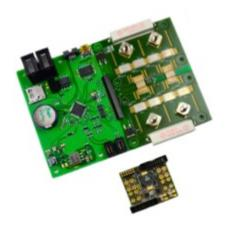
Das flexible Batteriemanagementsystem des Fraunhofer IIS ist in der Lage, unterschiedliche Konfigurationen von Batteriezellen überwachen zu können. © Fraunhofer IIS | Bild in Farbe und Druckqualität: www.iis.fraunhofer.de/pr.
