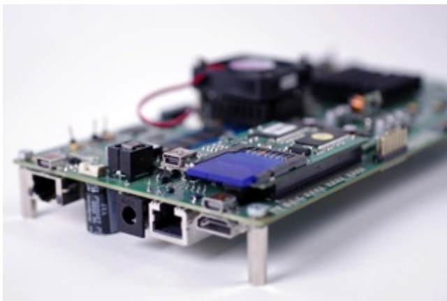
VEMPIRE® –Versatile embedded platform for image recognition. © Fraunhofer IIS/Bianca Möller | Bild in Farbe und Druckqualität: www.iis.fraunhofer.de/
