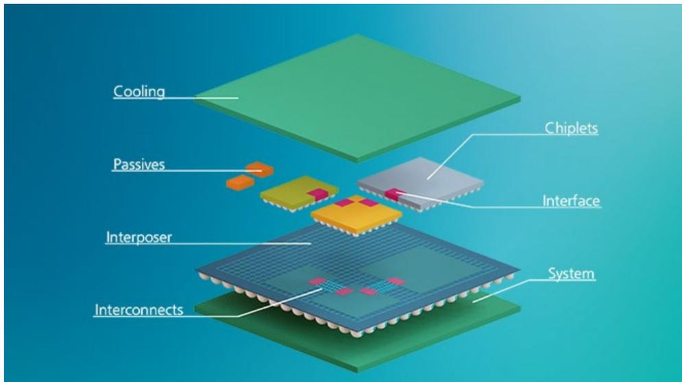
*Chiplets ermöglichen die Einbindung verschiedener Funktionseinheiten auch in unterschiedlichen Technologien auf einem Substrat oder in einem 3D-Aufbau, © Fraunhofer IIS/EAS*
